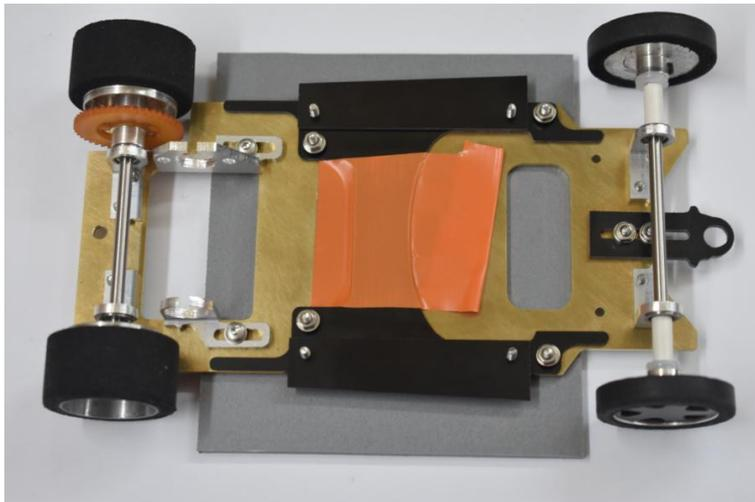
3. Karosseriehalter anschleifen. Zum besseren Halt der Verklebung.
