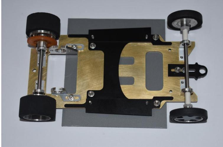
2. Fixieren Sie den Karosserieträger, mit Klebeband, am Chassi, so das der Karosserieträger am tiefsten Punkt sitzt.
